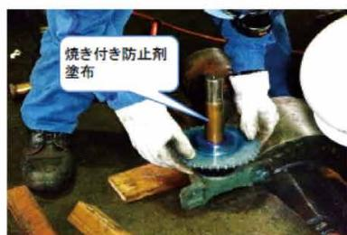
◇挿入時は、軸面に焼き付き防止剤を薄く塗布し
