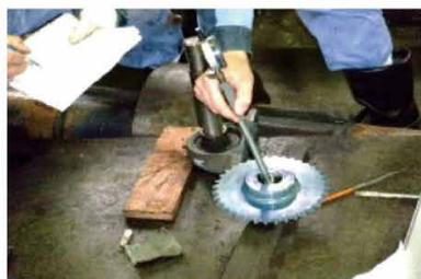
◇ギヤ穴径を測定し軸に入ることを確認する。
