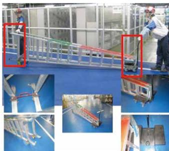
下部に車輪設置・上部を台車に乗せる
